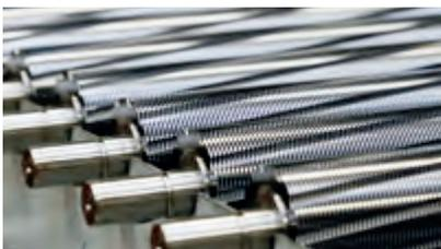
Los cilindros de corte de acero macizo endurecidos con garantía de por vida, pueden destruir fácilmente grapas y clips garantizando su durabilidad.
